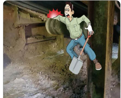
컨베이어 벨트와 드럼 사이에 끼임(사망 1)
