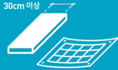
작업발판, 추락방호망 설치
