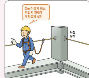
안전대 부착설비 설치
