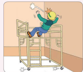
안전난간 미설치, 바퀴 미고정
