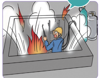
지하저수조에서 용접 중 방수제 유기용제 폭발
