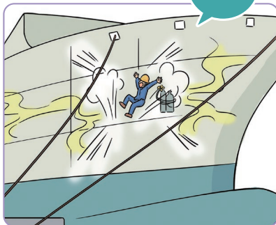
블록 내부 취부·용접작업 준비 중 화재·폭발
