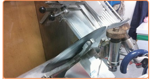
جب حفاظتی گارڈ ہٹایا دیا جاتا ہے 방호 덮개가 탈거 된 상태
