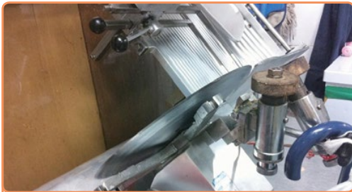
নিরাপত্তা গার্ড কখনো সরিয়ে নিলে। 보호 덮개가 탈거 된 상태
