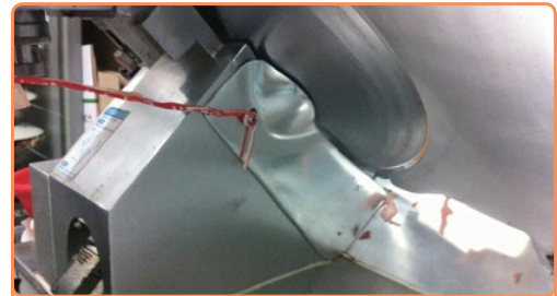
নিরাপত্তা গার্ড (ইন্টেরাল টাইপ)। 보호 덮개 (일체형)
