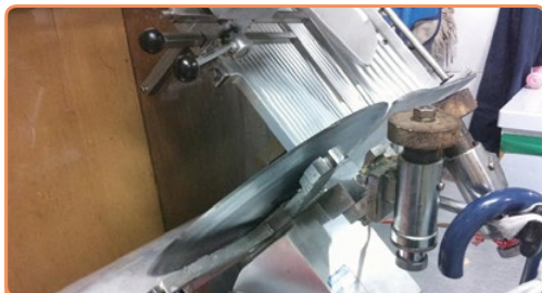
Khi tháo tấm chắn an toàn 방호 덮개가 탈거 된 상태
