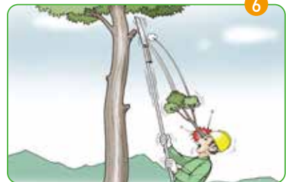
고지톱 이용하여 가지치기 작업 시 절단된 가지가 떨어져 눈 부상
