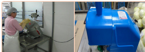
긴 깔대기 투입구 및 비상정지 스위치 설치
