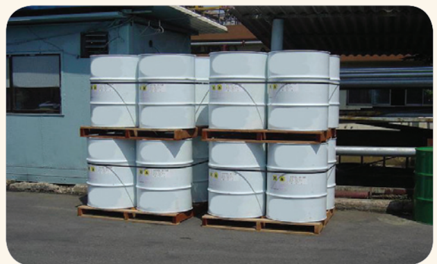
Load stable height (2 layers) (O) 안정된 높이(2단) 적재(O)
