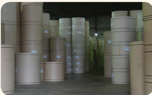
Load more than 3 layers or higher (X) 3단 이상 고단 적재(X)
