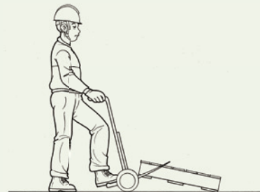
[ Improper use of handcart ] [ 부적절한 손수레 사용 ]
