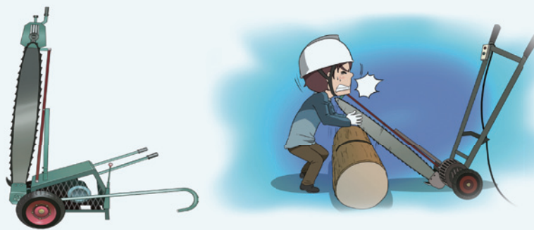
[ Máy cắt gỗ thô / Loại tai nạn dễ xảy ra khi sử dụng máy cắt gỗ thô ]
