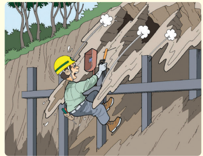
흙막이 설치 중 굴착면 무너짐
