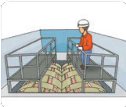
भ्यांग वरिपरि सुरक्षा रेलिड राख्ने 작업발판 및 안전난간 설치
