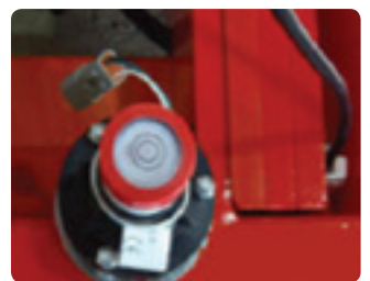
တိမ်းစောင်းမှု ညွှန်ပြစက် (အနိမ့်အမြင့် အာရုံခံကိရိယာ) 경사표시장치(수평감지센서)
