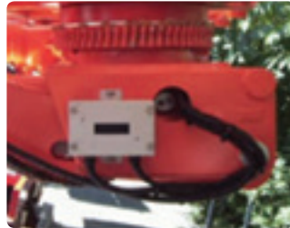
ওভারলোড প্রিভেনশন যন্ত্র (লোড সেল) 과부하방지장치(로드셀)
