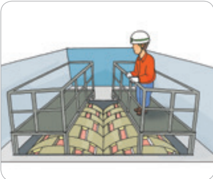
ভারার চারিদিকে সুরক্ষা রেলিং 작업발판 및 안전난간 설치
