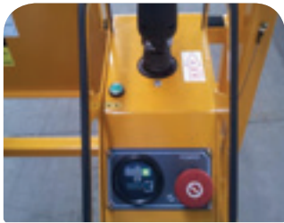
জরুরী ভিত্তিতে থামানোর বোতাম এবং কন্ট্রোল লক 비상정지장치 및 조작레버 잠금장치
