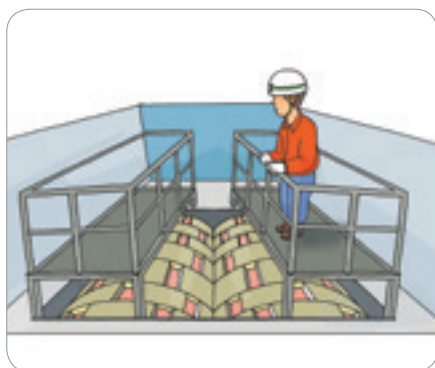
Rào chắn An toàn xung quanh Giàn giáo 작업발판 및 안전난간 설치
