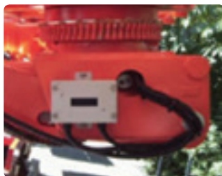
Thiết bị Chống Quá tải (bộ phận đo áp lực) 과부하방지장치(로드셀)
