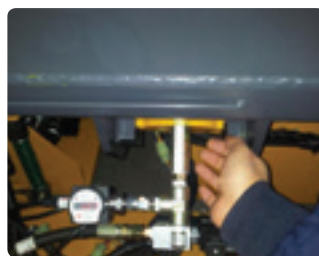
Van Chống Rơi (Van An toàn) 낙하방지밸브(안전밸브)
