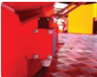
විවර්තනීය රිට්/හරස් දණ්ඩ එකට පැස්සීම 붐, 아웃트리거 인터록 장치
