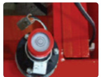
ආනතිය දක්වනය (සමතුලිත සංවේදකය) 경사표시장치(수평감지센서)
