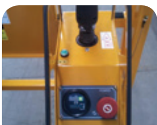
හදිසි නැවතුම් බොත්තම සහ පාලක අගුල 비상정지장치 및 조작레버 잠금장치
