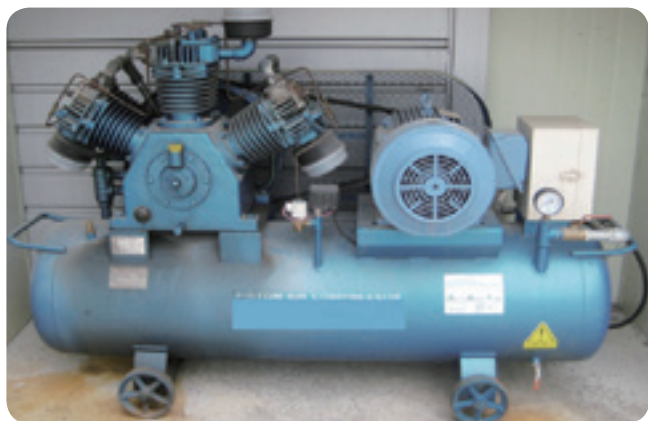
Поршенли ҳаво компрессори 왕복동식 공기압축기
