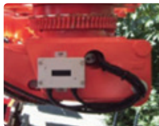
Perangkat Pencegah Kelebihan Beban (sel beban) 과부하방지장치(로드셀)
