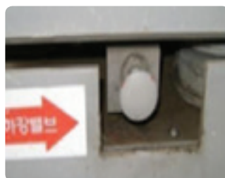
Perangkat Pengaman Darurat (Katup Turun) 비상안전장치(하강밸브)
