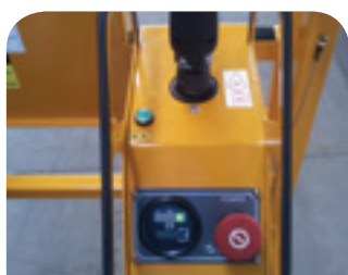
Tombol Berhenti Darurat dan Kunci Pengontrol 비상정지장치 및 조작레버 잠금장치
