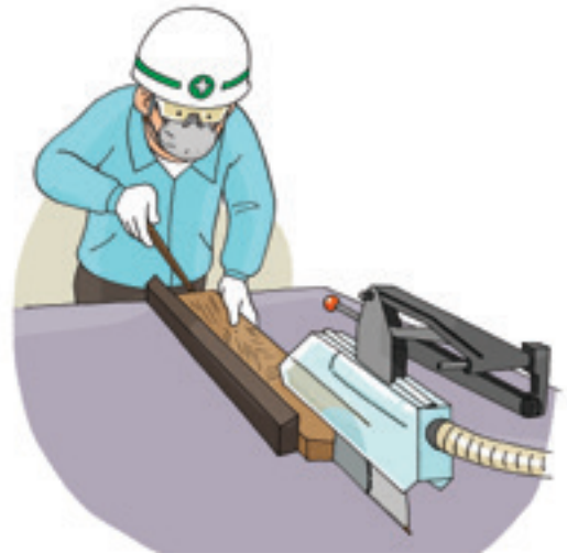
Menggunakan Tongkat Pendorong 푸시스틱 사용 예
