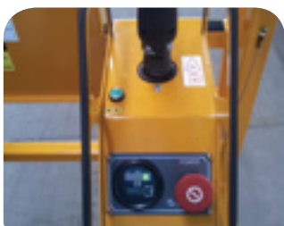
紧急停止装置及操作杆锁定装置 비상정지장치 및 조작레버 잠금장치
