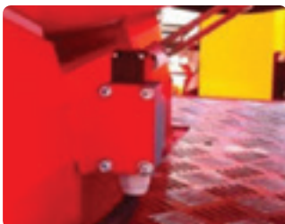
吊杆、桁架联锁装置 붐, 아웃트리거 인터록 장치
