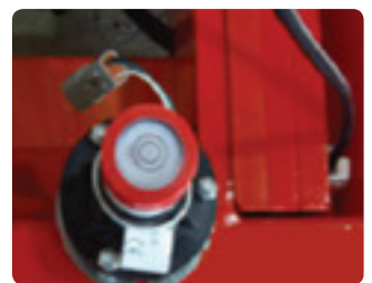
倾斜指示器（水平传感器） 경사표시장치(수평감지센서)
