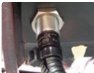
桁架传感器 아웃트리거 감지 센서
