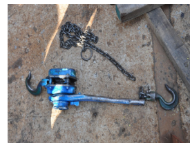
Zanjim yechishi dastagi qarshlangan zanjim yechishi dastagi (체인이 파단된 레버풀러)
