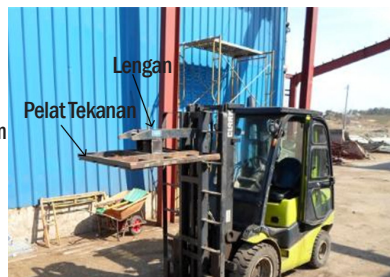
<Pelat tekanan dan lengan yang dipasang pada forklift> (지게차에 설치된 압력판 및 암)
