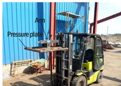
<Pressure plate and arm installed on the forklift> (지게차에 설치한 압력판 및 암)
