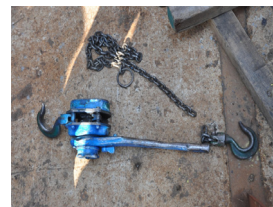
<链条断裂的杆柱> (체인이 파단된 레버풀러)
