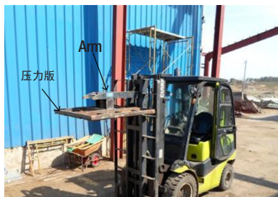
〈设置在叉车的压力版以及arm〉 (지게차에 설치한 압력판 및 암)
