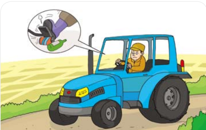
운전석 주변은 항상 청결하게 : 공구, 부품, 병 등은 브레이크 작동의 어려움 발생
