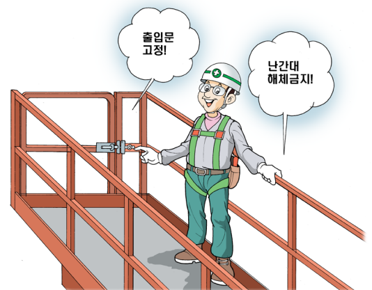
〈작업대 난간 및 출입문〉
