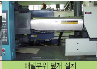
배럴부위 덮개 설치
