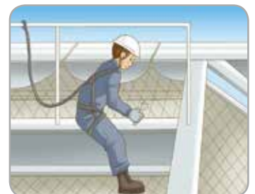
佩戴安全带与正确使用安全带 (안전대 착용과 올바른 사용)
