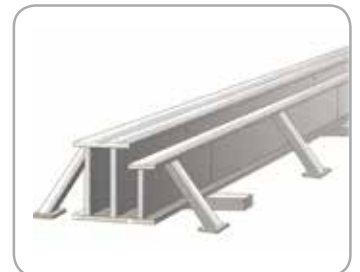
设置防倒支架 (전도방지 버팀대 설치)
