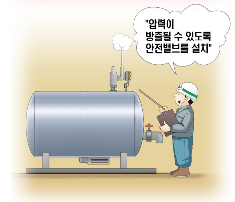
[과압 방지 안전밸브 설치]
