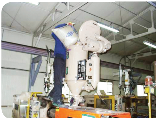
인력에 의한 호퍼 투입 작업
