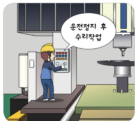
운전 정지 후 수리작업
