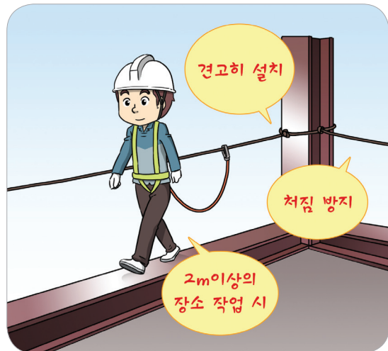
안전대 및 부착설비 설치
