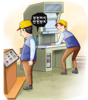
광전자식 또는 게이트 가드식 안전장치 설치
