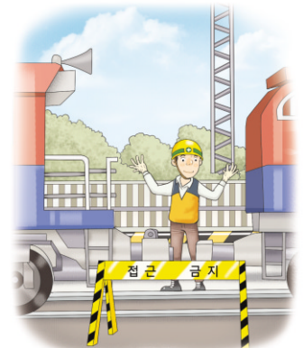
입환작업 시 출입금지 표지판 설치
