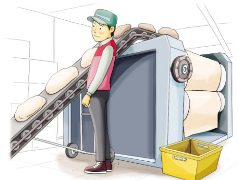
고무 투입용 컨베이어 설치
