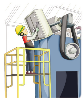
안전한 작업발판 설치
