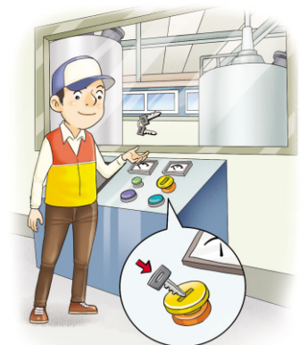
점검, 보수 작업 시 전원차단 후 스위치 잠금조치
