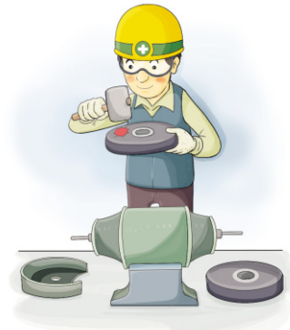
작업 전 연삭숫돌 외관검사를 실시
