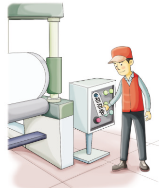
작업 시 운전정지 및 안내표지판 부착
