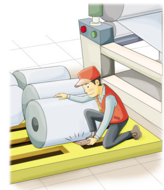
전도방지용 스톱퍼 설치
