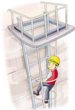
수직사다리 방호울 설치
