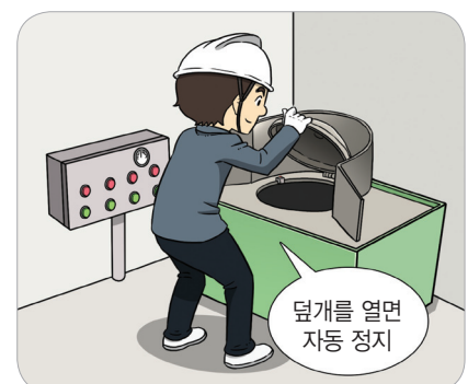
믹서기 덮개 설치
