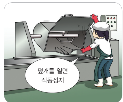
덮개 및 연동장치 설치
