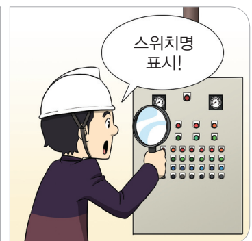
스위치별 명판 설치
