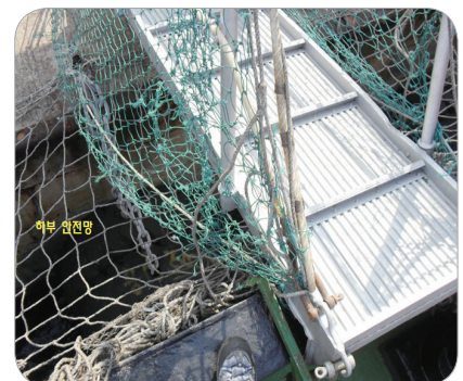
승강설비 하부에 안전망 설치
