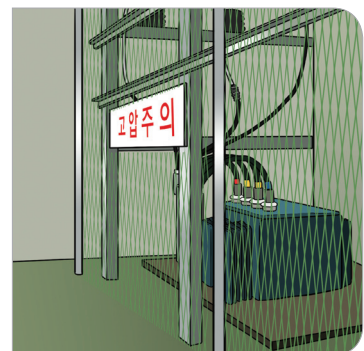
변압기 방호울 설치
